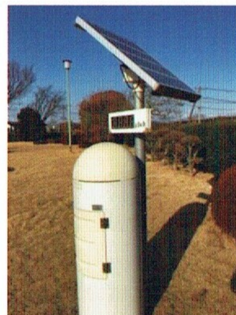
市民会館など公共施設には必ず線量計が 設置されています。
